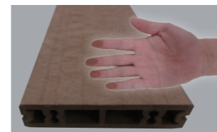
劣化によってチョーキングが発生（さわると粉がつく）
