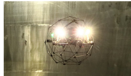
機体直径40cm、保護フレーム構造 点検対象に極めて接近し、撮影可能です。
